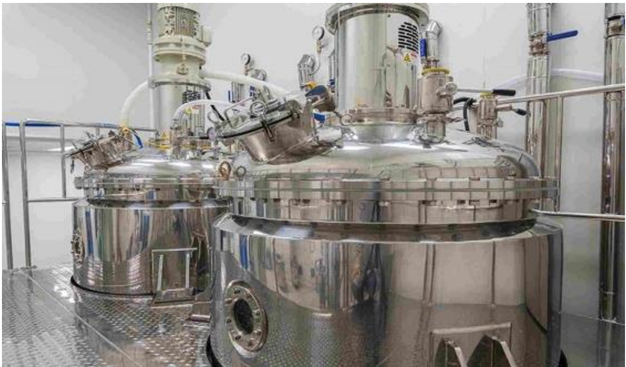
۲. راکتور مخزن همزن دار پیوسته (CSTR)
